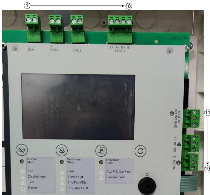
Fig. 16: Secuencia de conectores de la placa base
